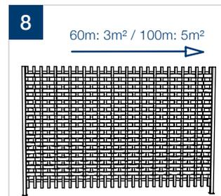
8 El rendimiento para el rollo de 50m es de aproximadamente 3m² de alambrado, y para el de 100m, de 5m².
